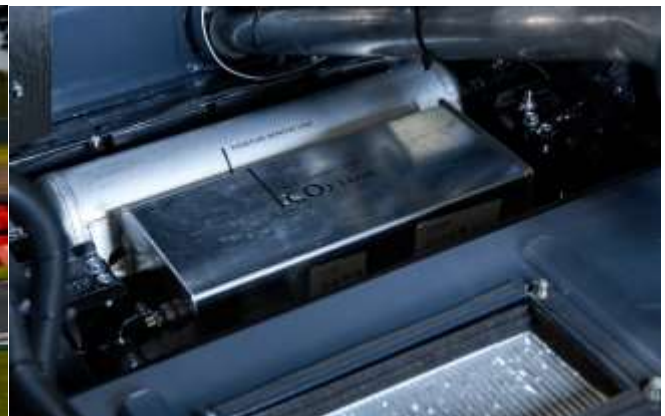
Sistema de captura de CO 2 instalado en el vehículo de demostración
